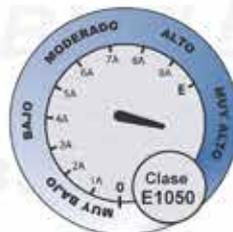
Ensayo según norma UNE-EN 1027:2000
